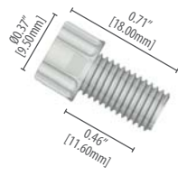
002230 ETFE nut for 1/8" OD tubing 1/4•28, natural
